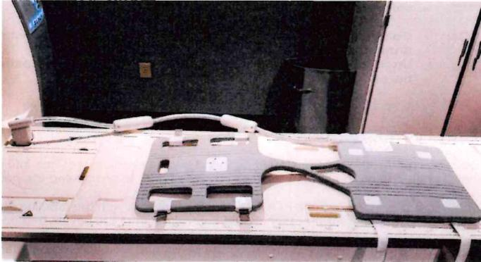
**Abbildung 5:** Bauchlage mit dem Kopf voran vor dem Beladen des Patienten. Die Bohrung befindet sich auf der linken Seite und die vordere Seite der Spule befindet sich auf der linken Seite.
