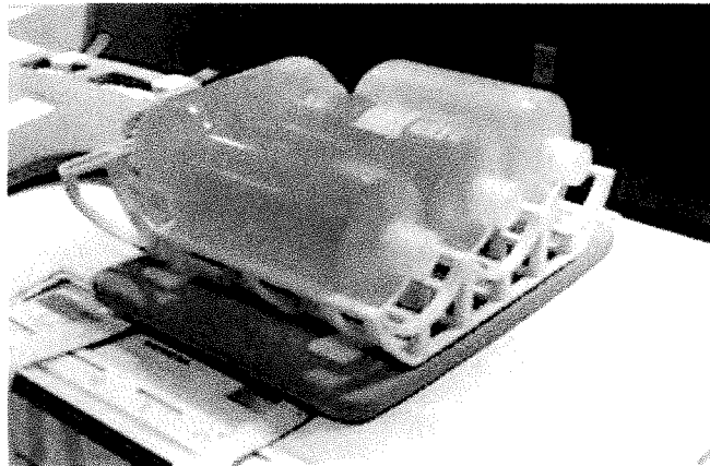
Abbildung 17: Phantomstellung in der Spule. Flach auf dem Tisch spulen.
