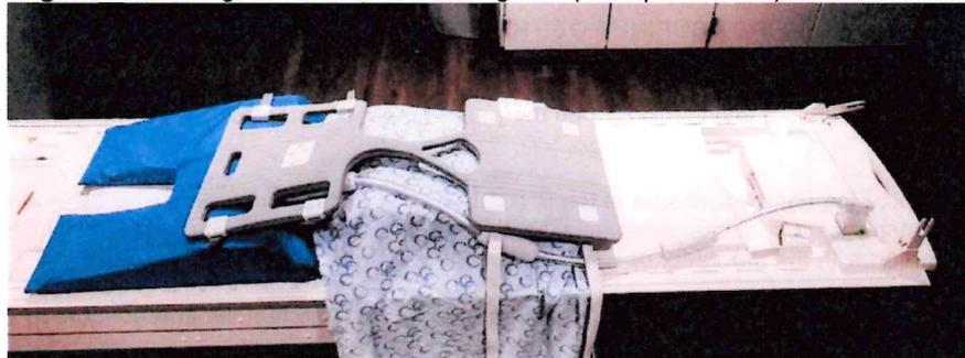
Figure 12: Configuration initiale de la tête la première avant le chargement du patient et utilisation de la doublure chirurgicale. L'alésage est à gauche
